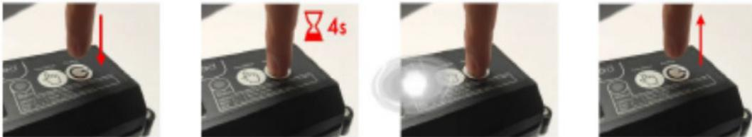
2. Dein Tom verbindet sich nun mit dem WLAN Netzwerk. Das Blinken der LED in **Magenta** bedeutet, dass das Gerät das WLAN Netzwerk erfolgreich gefunden hat und unterdessen Daten sendet. Sobald die Status-LED **Grün** blinkt, wurde das initiale erste Foto gesendet.
